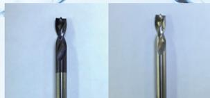
鉄合金上のチタン及びクロム系のイオンプレーティング膜の除膜事例
