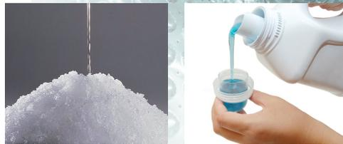
左:高吸水性樹脂「サンウェット」。吸水してゲル化し、多少の圧力では水を離さない。紙おむつなどに利用されている。
