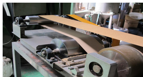
図2 紙帯にすべり剤を処理している過程
