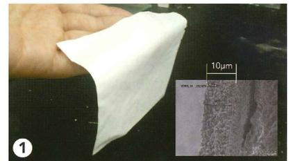
図3 リチウムイオン電池用のモノリスセパレータ
