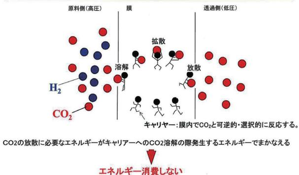
選択的膜分離のメカニズム
